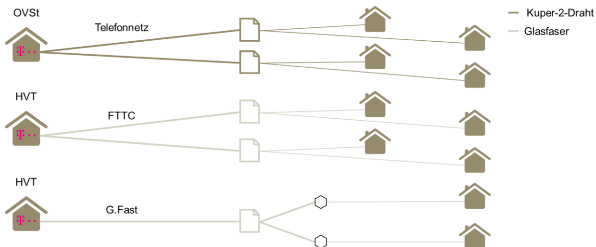
Abbildung 8: Struktur des Kupfer-2-Draht-Netzes mit xDSL-Erweiterungen [2]
